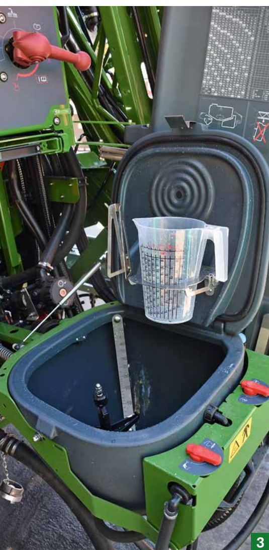
◁ 1) Le pulvérisateur est très facile à atteler et à dételer. 2) La centrale de commande est bien ordonnée. 3) Le bac incorporateur, d'une contenance de 60 l, dispose désormais entre autres d'un support pour le verre doseur.
