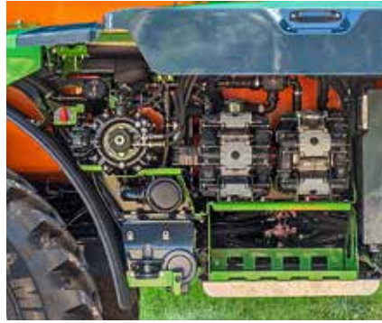
Die Pumpen von Comet sitzen rechts vom Tank und leisten 260 + 350 l/min.
